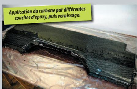
Application du carbone par différentes couches d'époxy, puis vernissage.
