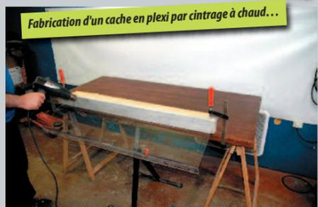
Fabrication d'un cache en plexi par cintrage à chaud...
