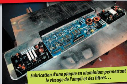
Fabrication d'une plaque en aluminium permettant le vissage de l'ampli et des filtres...
