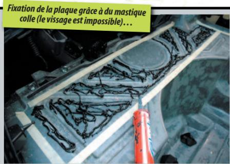
Fixation de la plaque grâce à du mastic colle (le vissage est impossible)...
